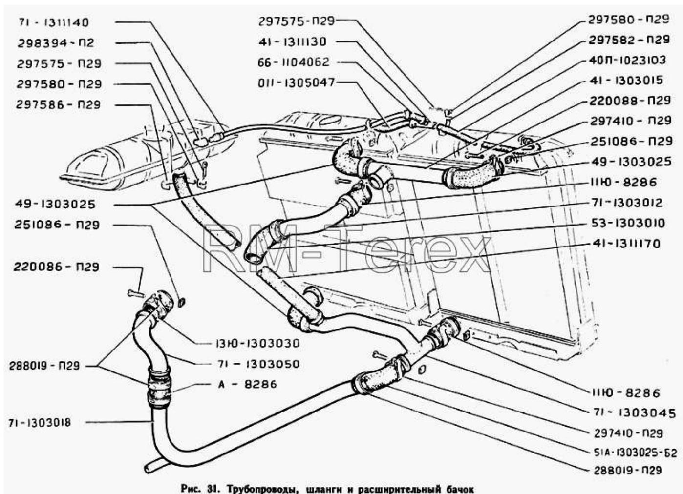
Рис. 31. Трубопроводы, шланги и расширительный бачок
