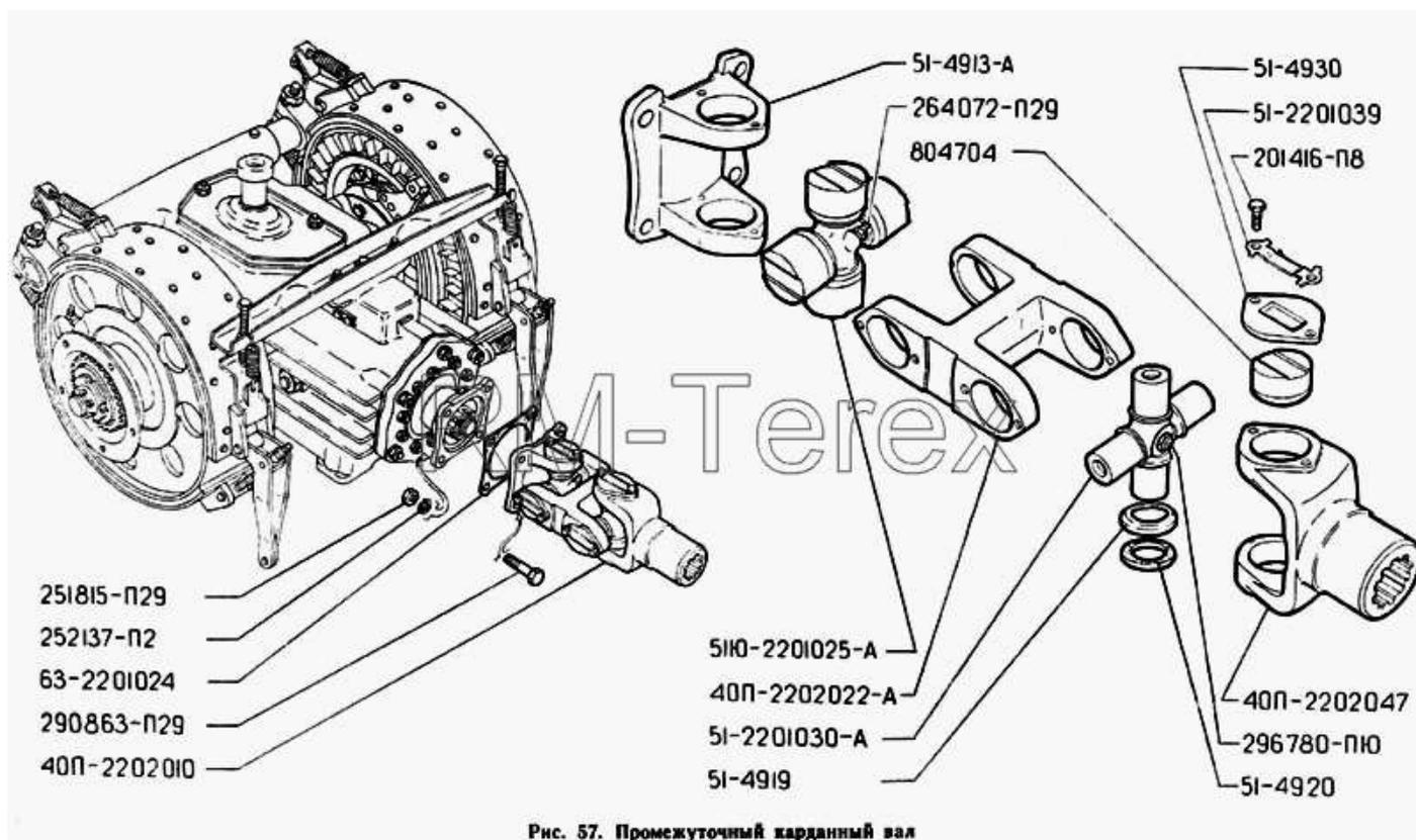
Рис. 57. Промежуточный карданный вал
