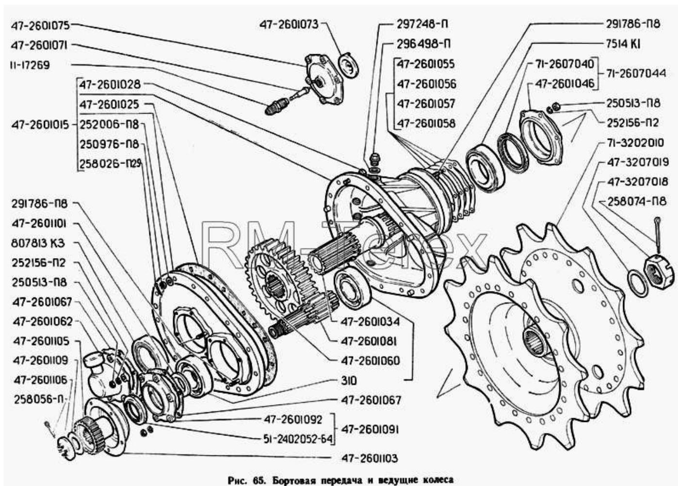
Рис. 65. Бортовая передача и ведущие колеса
