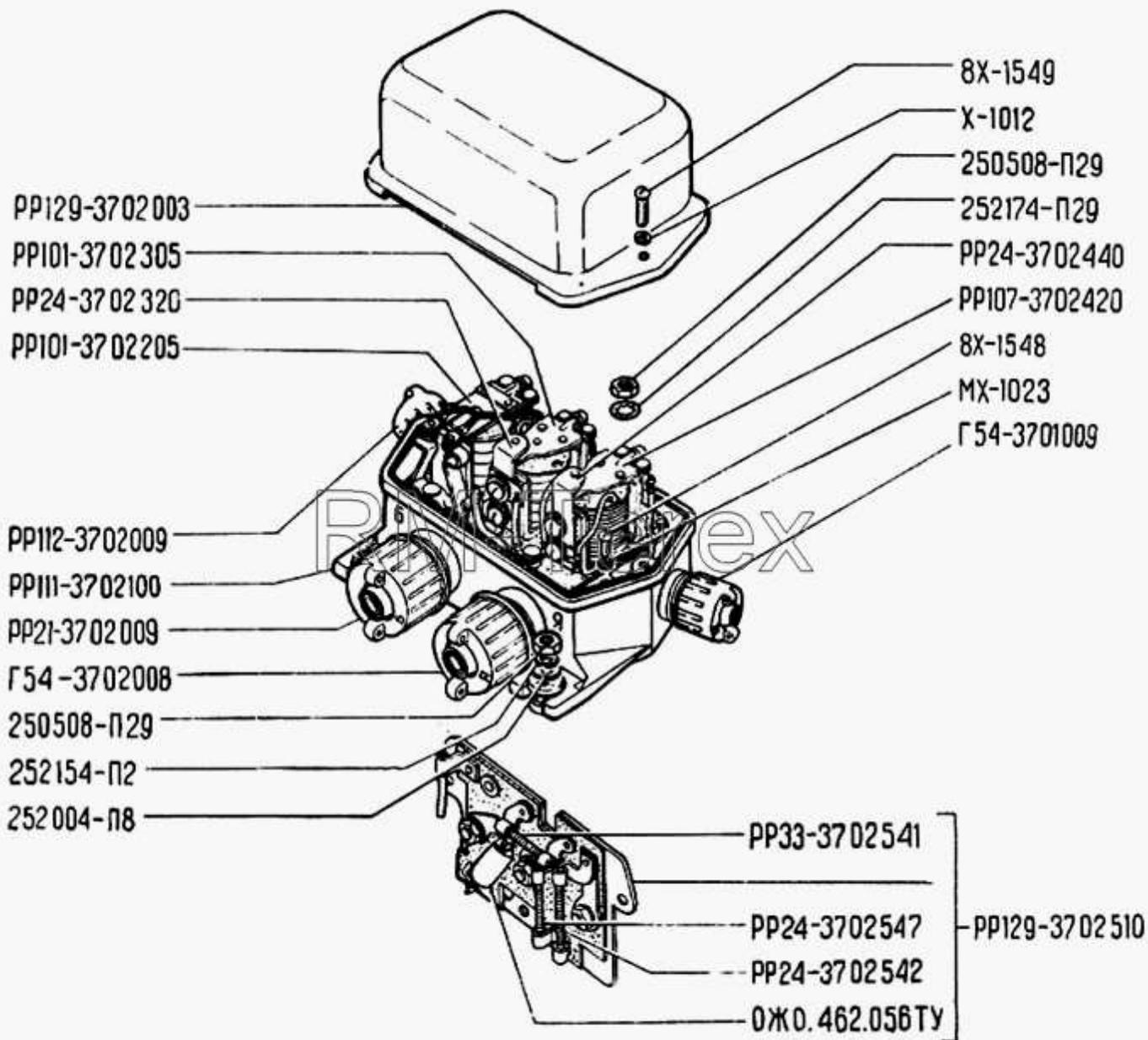
Рис. 83. Реле-регулятор
