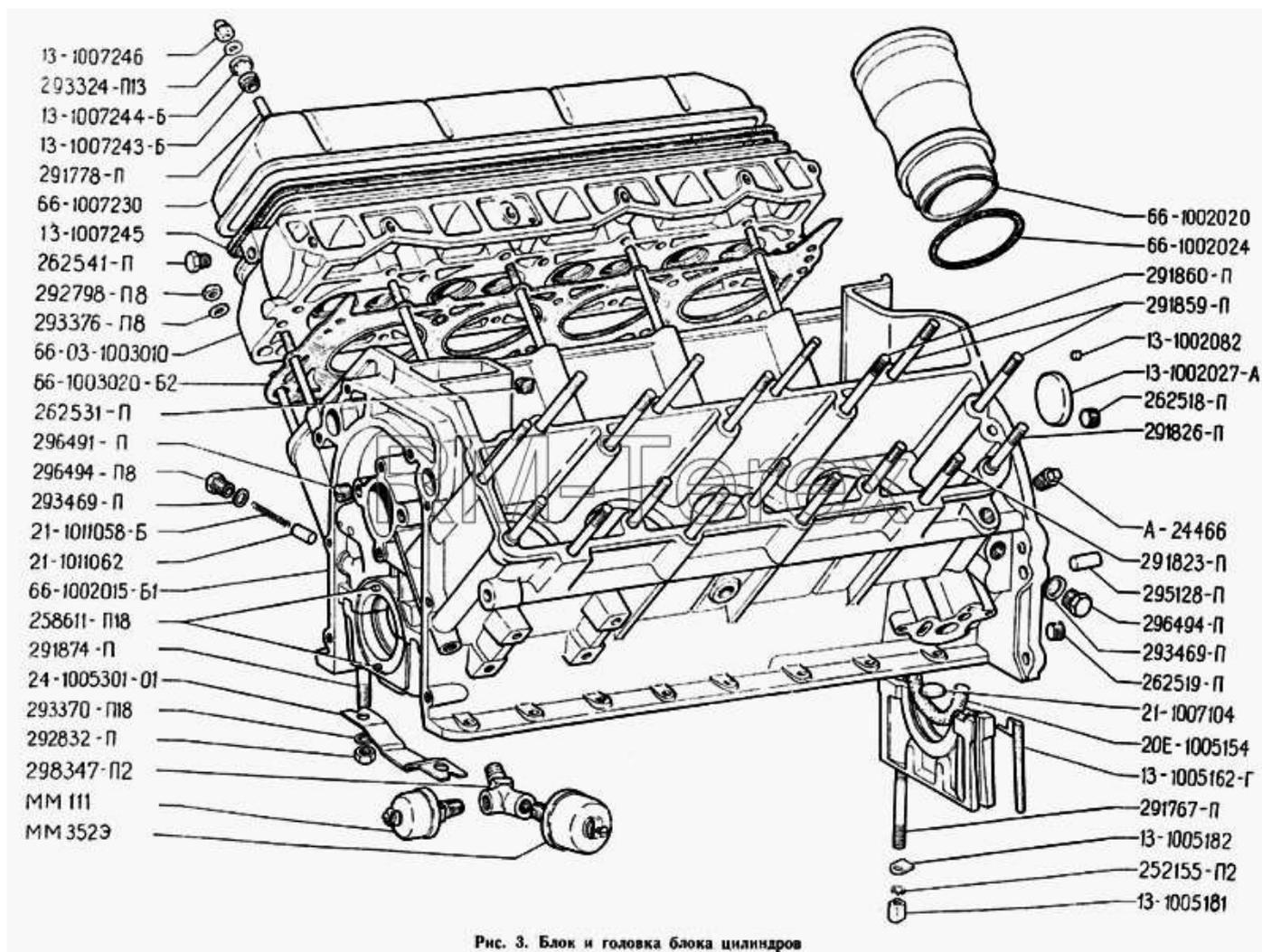
Рис. 3. Блок и головка блока цилиндров
