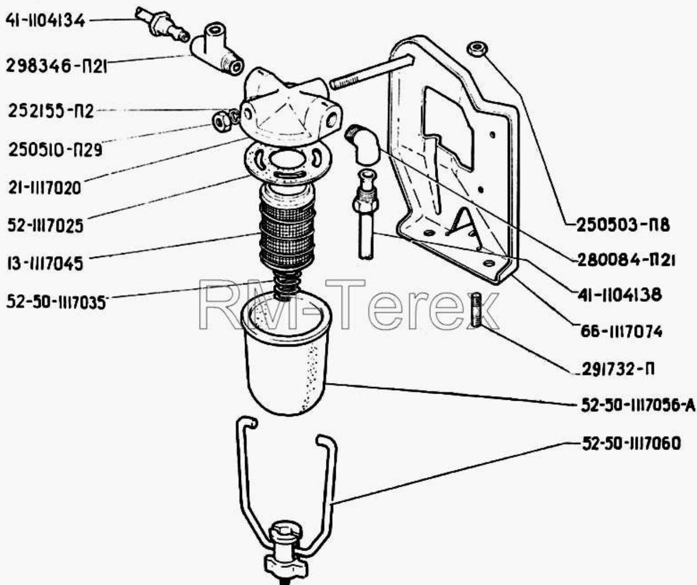
Рис. 28. Фильтр тонкой очистки топлива
